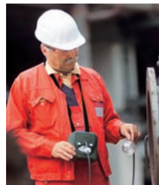
Dräger X-am 7000: Eine integrierte Hochleistungspumpe vereinfacht Freigabemessungen.
